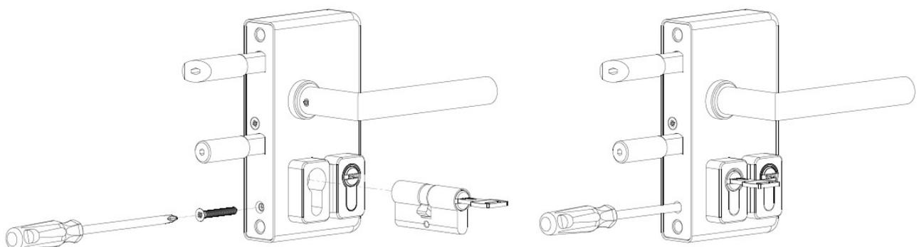
AUSBAU der Zylinder – o.g. Anleitung in umgekehrter Reihenfolge.
