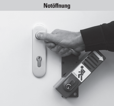
Durch Schwenken rastet der Türwächter ein und gibt den Betätigungsweg der Klinke frei. Gleichzeitig ertönt ein Alarm.
